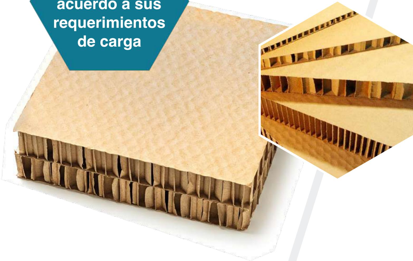
Podemos fabricar los paneles con diferentes calidades de revestimiento, pero por lo general está entre 125 y 750 gramos por m<sup>2</sup>. De manera similar, el núcleo (la estructura de la celda) viene con diferentes espacios, típicamente de 10 a 20 milímetros. La altura de los paneles de nido de abeja varía de 10 a 110 milímetros.
